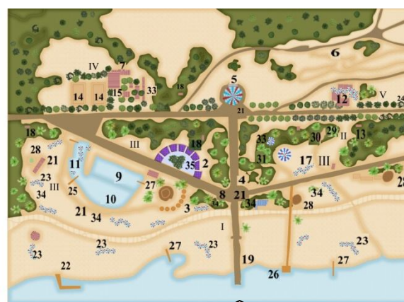
2-расм. Кенг соҳилда жойлашган пляж комплекслари бош режасининг схемалари. I–умумий пляж, II–болалар сектори, III–ўтлоқ устидаги солярий; 1–кириш жойи, 2–ечиниш жойи, 3–ечиниб олиш кабиналари, 4–чодир ости қахвахона, 5–ошхона, 6–кўтқариш станцияси, 7–инвентарлар прокати, 8–савдо дўкони, 9–томошабинлар жойига эга сузиш бассейни, 10–сузишни ўрганмаганлар учун бассейн, 11–болалар бассейни, 12–болалар ўйин майдончаси, 13–теннис корти, 14–волейбол майдончаси, 15–баскетбол майдончаси, 16–стол тенниси, 17–дам олиш павильони, 18–ҳожатхона, 19–аэрарий, 20 – кўрсаткич, 21–ўтиргичлар, 22–лодкалар причали, 23–соёбонлар, 24–лианлар, 25–тобоган, 26–болалар учун сув манежиклари, 27–сувга сакраш минораси, 28–соёбон, 29–қозикларга ўрнатилган хонача, 30–болаларни сирпаниш жойи, 31–кема, 32–кетельбан, 33–сув ичиш фавворалари, 34–декоратив бассейн.
