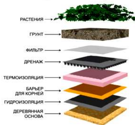
Рис 1. Пирог стандартной «Зеленой кровли».
