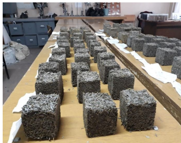
2-расм. Гуруч қипиғидан тайёрланган намуналар.
