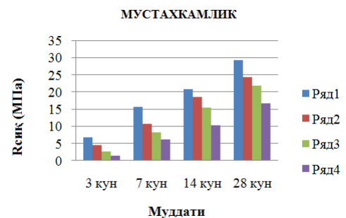
2-расм. Тадқиқот асосида ҳар хил суперпластификаторлардан фойдаланган ҳолда бетоннинг кубикавий мустаҳкамлиги
