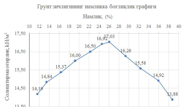
3-расм. Грунт максимал зичлиги учун оптимал намлик топиш графиги
