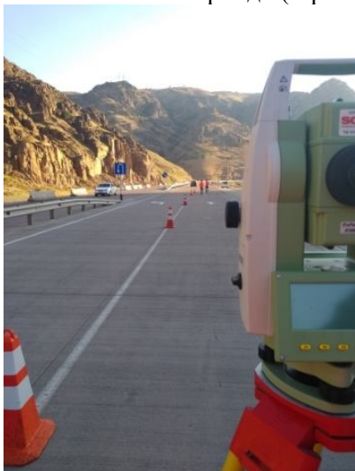
1-расм. Тадқиқот участкасида цементбетон қоплама юзасининг бўйлама профилини ўлчаш ишлари
