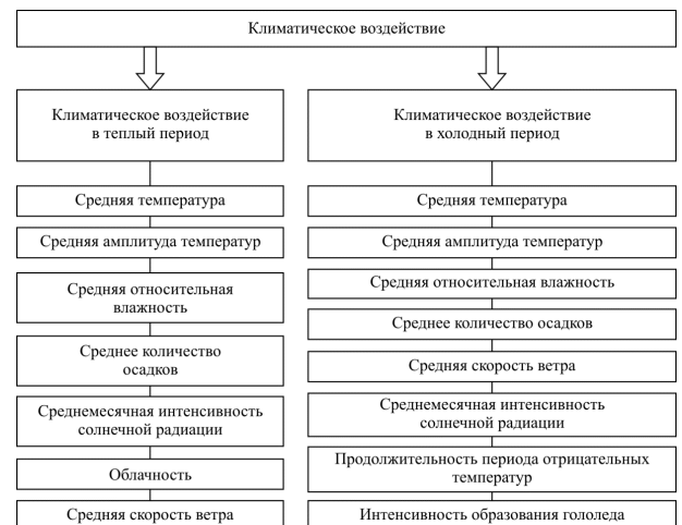
Рис.1. Схема формирования интегрального показателя отрицательного погодноклиматического воздействия на изменение ровности по индексу IRI
