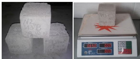
2-расм. Синаш учун тайёрланган фиброгазобетон намуналари
