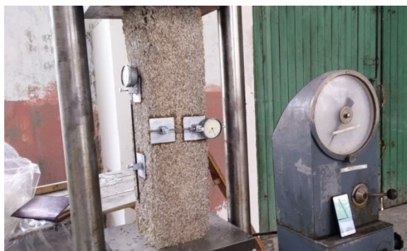
4-расм. Гуруч қипиғидан тайёрланган 10x10x60 см призматик намуналар. Ўта енгил бетоннинг призматик мустаҳкамлиги 28 кунлик натижалари.
