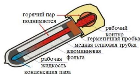
Рис.4. Принцип работы вакуумного солнечного коллектора с тепловыми трубками
