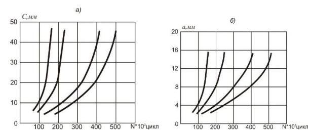
Рис.2 а,б Распространение поверхностной трещины в глубину и на поверхности образца при различных уровнях напряжения.
