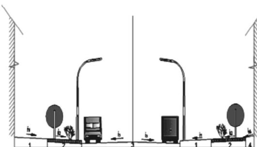
Рис. 1. Поперечное сечение улицы: 1 – тротуар; 2 – газон; 3 – проезжая часть; 4 – отмостка;  $i_1$ ;  $i_2$ ;  $i_3$ ;  $i_4$  – соответственно поперечные уклоны: тротуар, газон, проезжая часть, отмостки.
