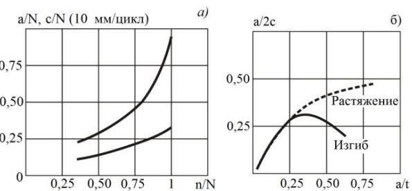
Рис.3 Обобщенные графики: а – скорости роста трещины в глубину и длину при уровне циклического нагружения 0,7  $\sigma_{0,2}$ ; б – кинетика роста трещины при изгибе
