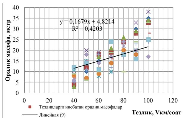
3-расм. Автомобилларнинг оралиқ масофаларини график орқали кўриш.
