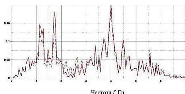
Рис. 6. Спектр исходной акселерограммы и спектр ускорений середины плиты 16-этажного здания
