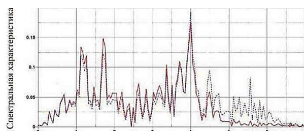
Рис. 5. Спектр исходной акселерограммы и спектр ускорений середины плиты 9-этажного здания.
