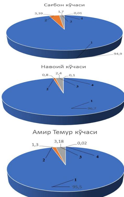
4-расм. Ҳаракат таркибининг ўзгариши. 1-енгил автомобил; 2-юқ автомобили; 3-автобуслар; 4-веломототранс.
