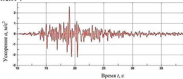
Рис.2 Акселерограмма внешнего воздействия
