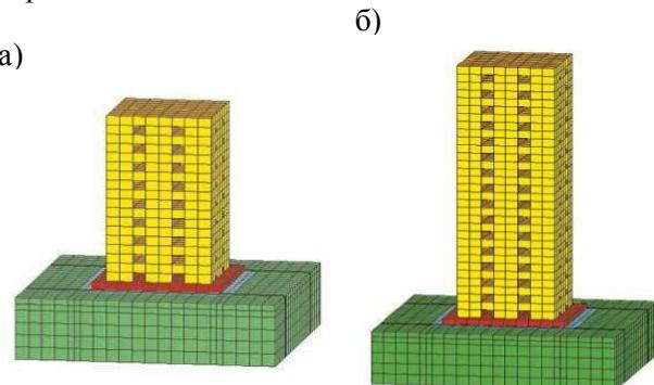
Рис. 1. Расчетная модель: а — 9-этажное здание; б — 16-этажное здание.
