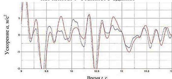
Рис. 4. Исходная акселерограмма ускорения середины плиты 16-этажного здания
