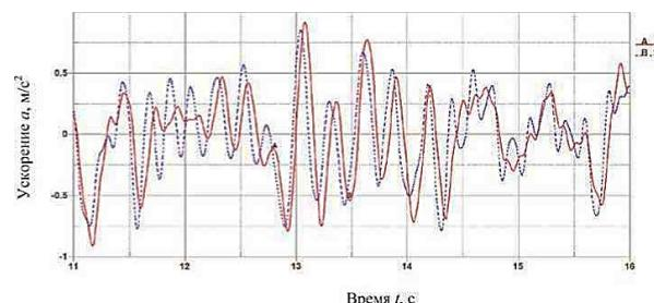
Рис. 3. Исходная акселерограмма ускорения середины плиты 9-этажного здания
