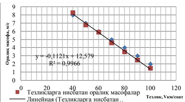
4-расм. Автомобилларнинг оралиқ масофаларини экспоненциал график орқали кўриш.
