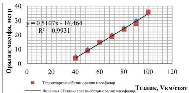
2-расм. Автомобилларнинг оралиқ масофаларини экспоненциал график орқали кўриш.
