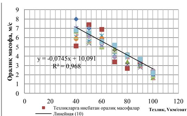
5-расм. Автомобилларнинг оралиқ масофаларини экспоненциал график орқали кўриш
