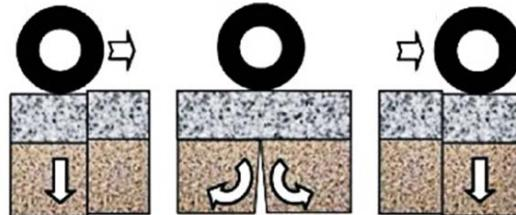
Рис. 3. Механизм образования отраженных трещин из-за воздействия нагрузки транспортных средств
