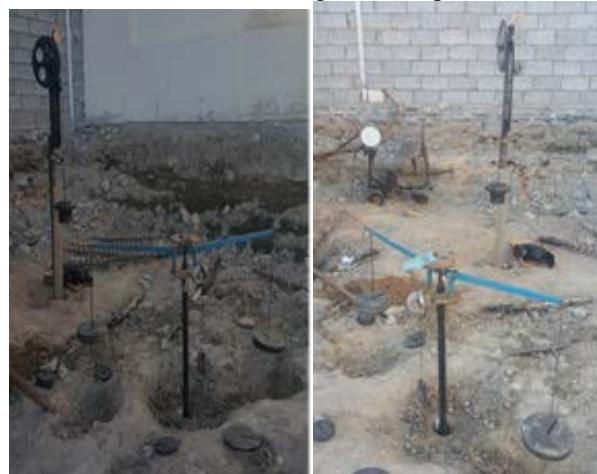
Рис.4. Испытания с песчанным и лопастным прессиометром.
