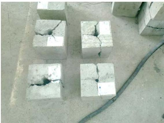
Рис.2. Характер разрушения опытных образцов
