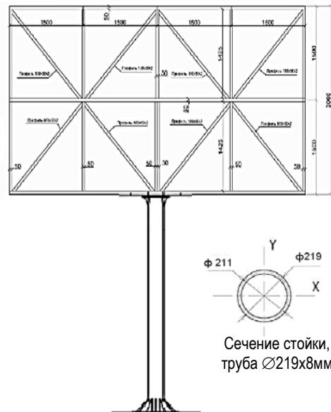
Рис.1. Конструкция рекламного щита.
