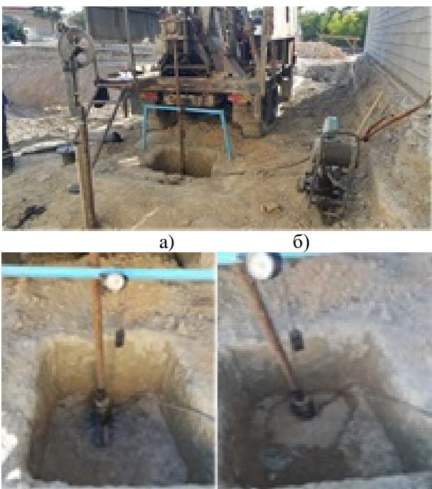
Рис.5. Площадка для проведения комплексных испытаний штампами. а) штамповые испытания в грунтах природной влажности и б) в водонасыщенном состоянии.
