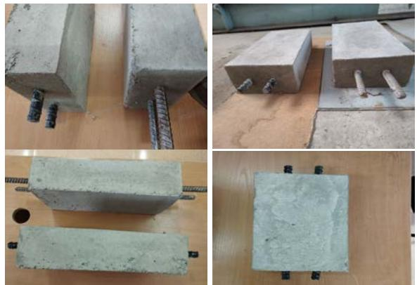
1-расм. Базалт композит арматура, темир арматура ва бетон қоришмалари асосида олинган бетон плиталар намуналари.
