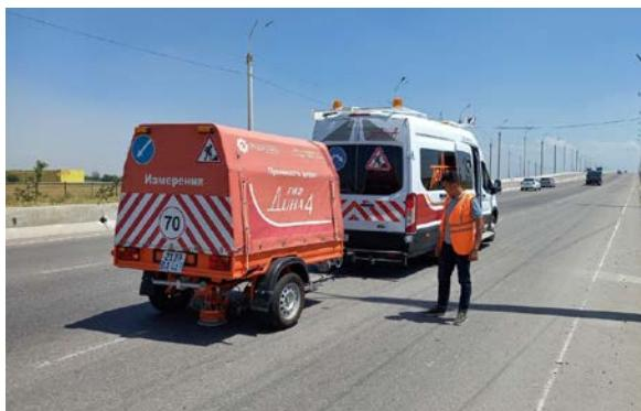
1-rasm. Trassa kompleks yo'l laboratoriyasi yordamida 4P21 avtomobil yo'lida transport-ekspluatatsion ko'satkichlarini aniqlash jarayoni.
