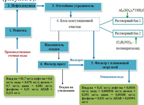
Рисунок 5. Схема очистки производственных сточных вод
