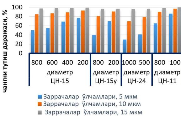
1-расм. Якка циклонларда чанг оқими заррачаларини тутиб қолиши самарадорлигининг циклон диаметри ва чанг заррачаси ўлчамига боғлиқлик графиги
