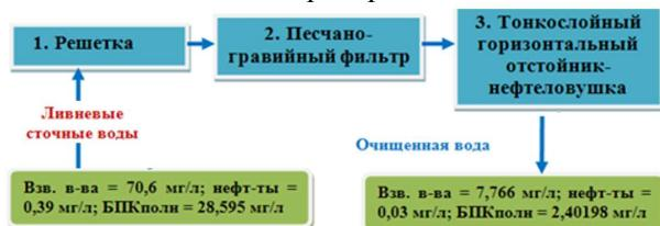
Рисунок 6. Схема очистки ливневых сточных вод
